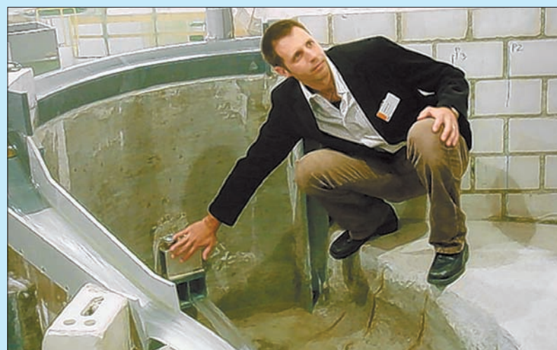
Christof Oertli, Projektleiter Bautechnik, EWZ, erklärt an der Modellstaumauer wie das Kies und der Sand über die Grundablässe weggeführt werden können.
