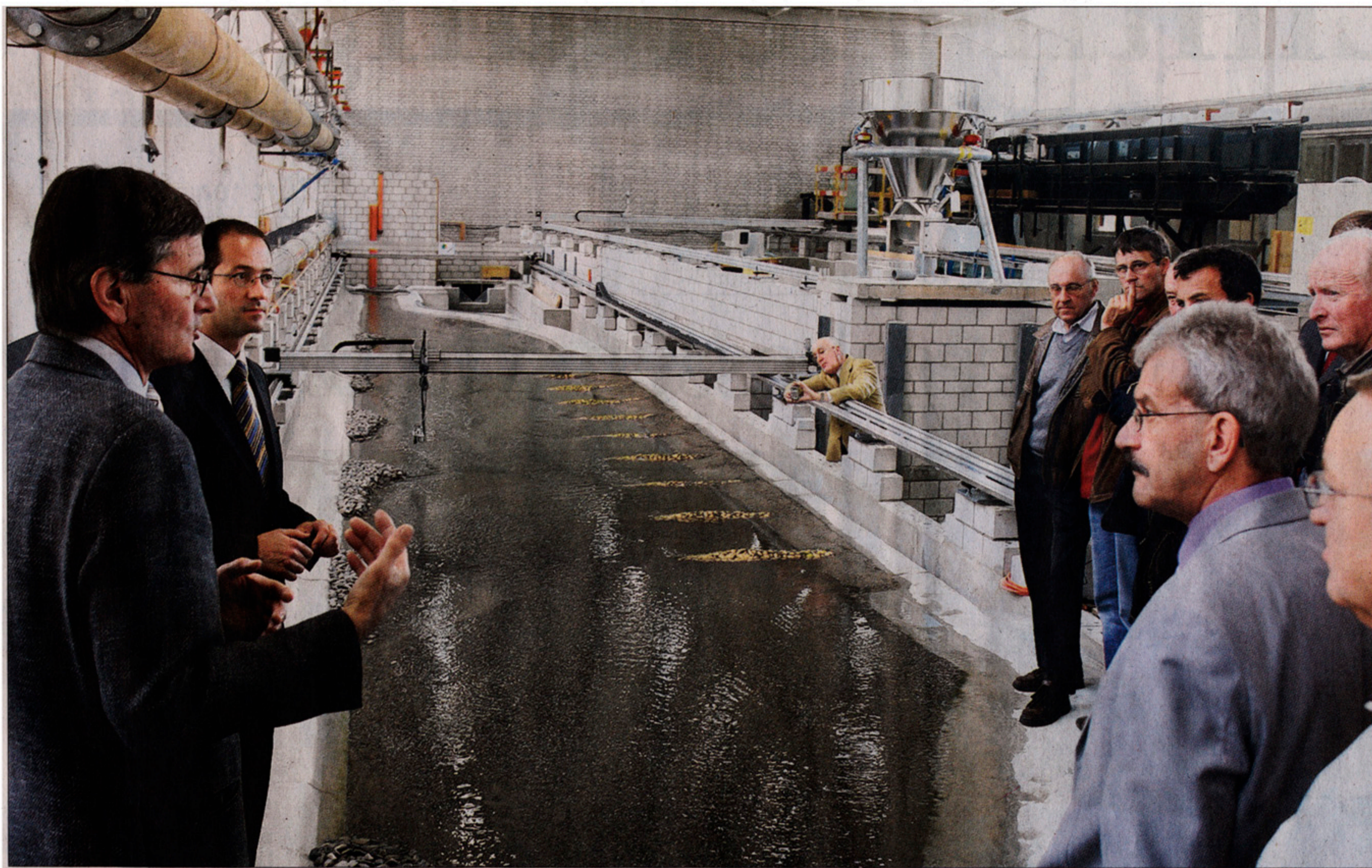
In der ETH Zürich gibts Hochwasser per Mausclick: Regelmässig wird der Mini-Escherkanal geflutet. Mittels Laser werden Daten zum Strömungsverlauf erfasst. Der Versuch soll unter anderem die optimale Anordnung der Buhnen (gelb) aufzeigen, wie Professor Hans-Erwin Minor (links) erklärt. (Gerl Schedl)
