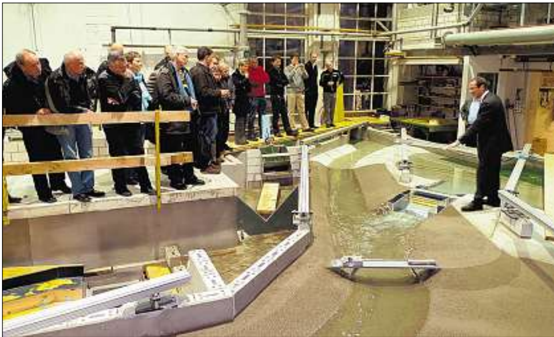
Eine Entlastungssituation am Modellwehrr zeigt, wie und wo das Wasser abfließt. Bild zvg
